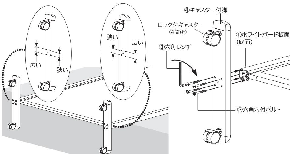
以上で組立は終了です。ホワイトボード板面に脚のネジがしっかりと締め付けられているか再度確認してください。
