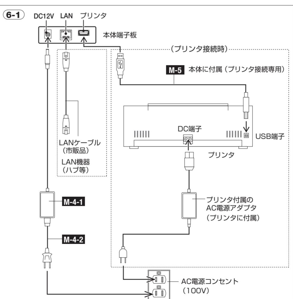
動作確認済みプリンタの AC 電源アダプタは接続図と異なっている機種 (内蔵タイプ・組付けタイプ) もありますか接続は同じ要領で行ってください。(プリンタの仕様に準じます。)
