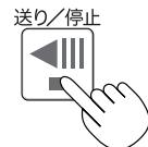
送り／停止 ボタンを押すとシート面を 1 面分左にスクロールして自動停止します。
