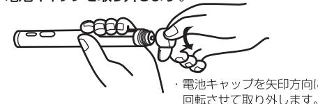
電池キャップを矢印方向に回転させて取り外します。
